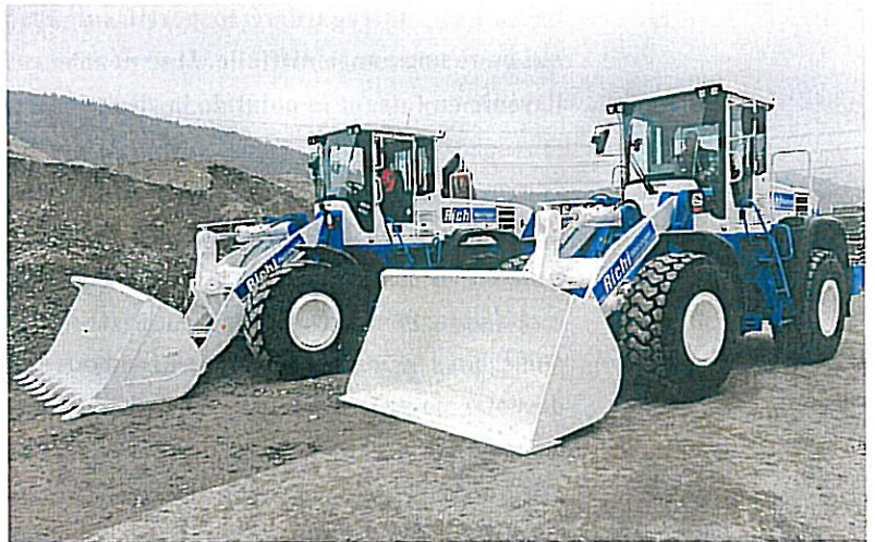
Richi Weiningen erhält zwei Hyundai HL757-9 mit 14,5 Tonnen Einsatzgewicht und 2,8 Kubikmeter Schaufelinhalt. Foto: pd
